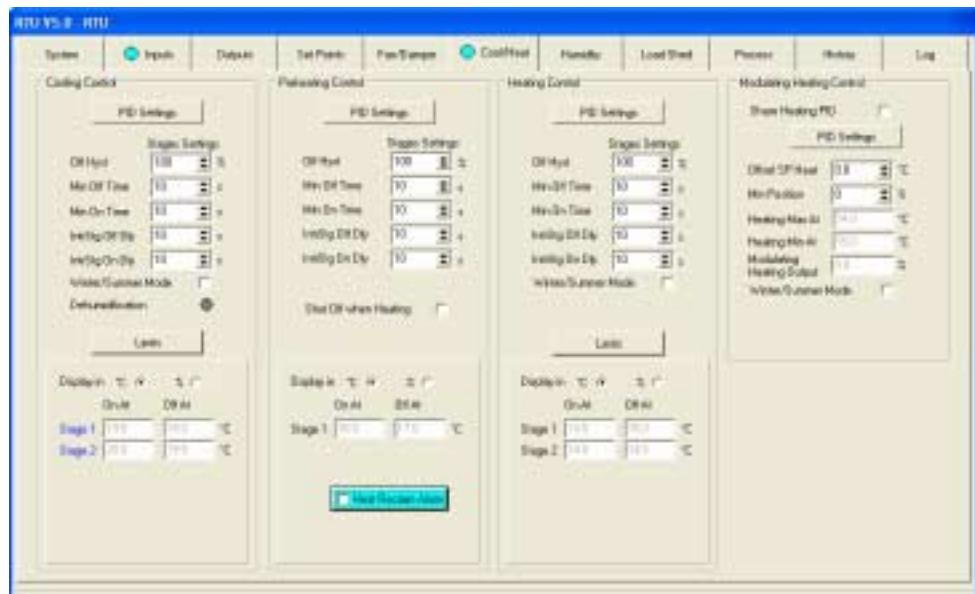
Pour activer ce type d'alarme il faut remplir ce nouveau formulaire sous l'onglet Cool/Heat du plugin du RTU
