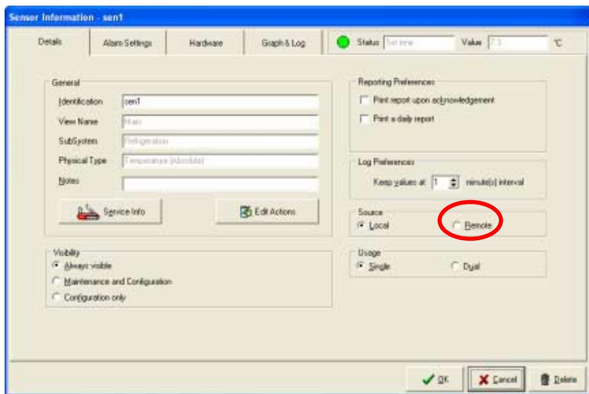
Ce qui activera la boîte **Remote Source** de l'onglet **Hardware**. C'est dans cette boîte qu'il est possible de choisir la source qui utilisera les limites d'alarmes de l'onglet **Alarm Settings**.
