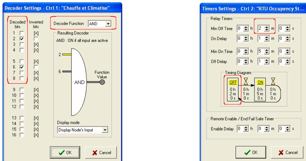
L'état des bits est affiché et sont comparés avec des fonctions booléennes. Le délai optionnel appliqué est configurable.
