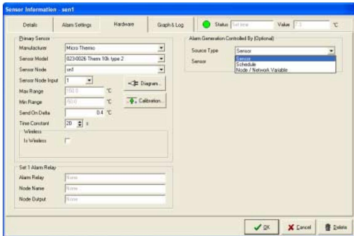
Les alarmes peuvent être désactivées par un bouton physique branché sur un nœud à capteur, par une variable SNVT\_Switch d'un nœud (**custom node**) ou par une commande provenant du nouvel horaire de réfrigération. Il n'est pas possible d'utiliser cette option pour le même capteur que la fonction d'interrupteur à double usage (**Dual use**) car ils utilisent tout deux le même objet d'entrée.
